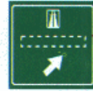
Otoyol Bilgi İşaretleri (Refüj Odası Yön Levhası)
